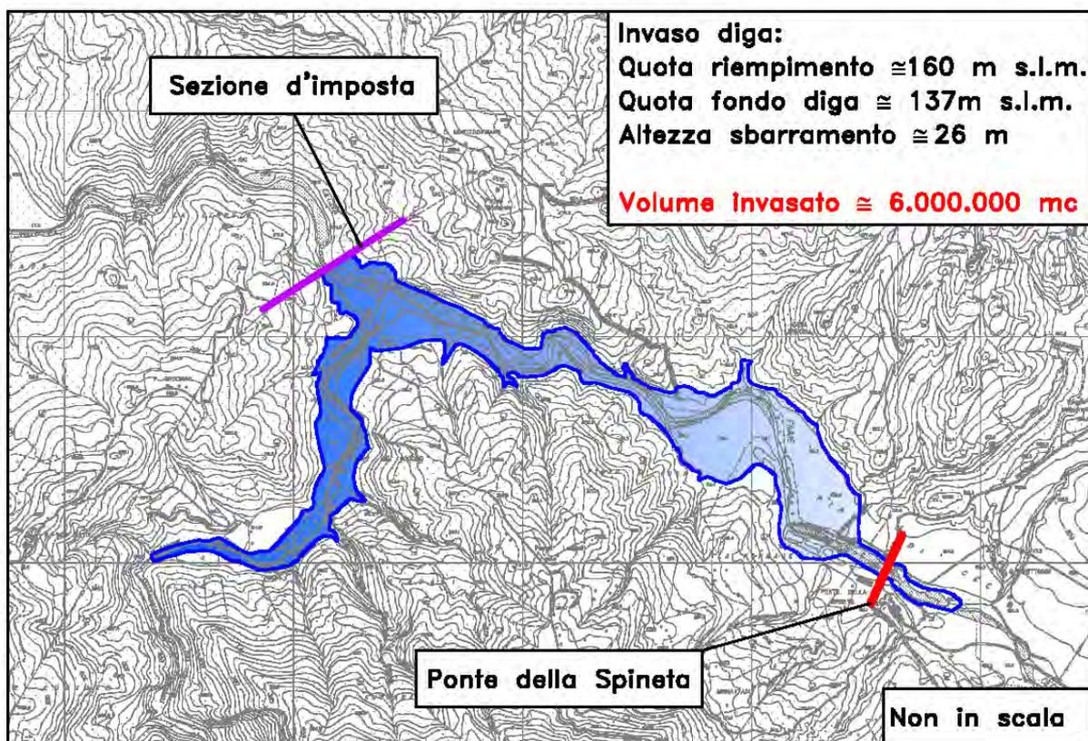
Fig.6.1A - Ipotesi di sbarramento 5 e 6. Invaso con volumetria di 6 Milioni di mc
